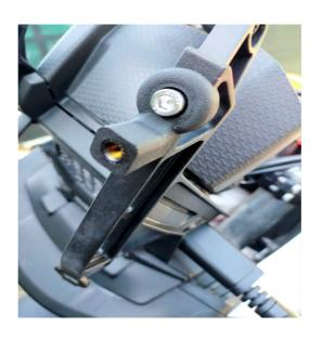
3 – FIT THE RALLY WINDSHIELD USING THE 4 ORIGINAL SCREWS USING THE RUBBER WASHERS.
